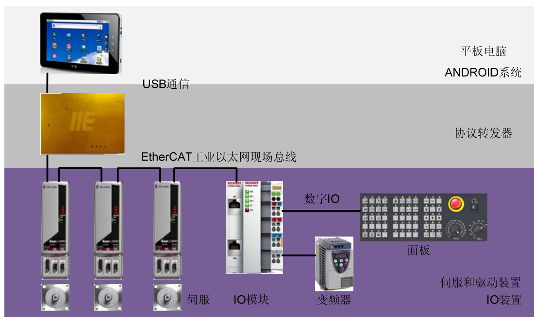
图 2 电气控制系统结构
