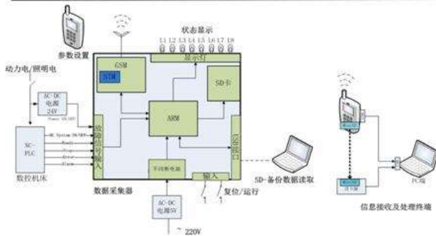
设备故障信息无线采集系统示意图
