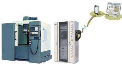
设备故障信息无线采集系统示意图
