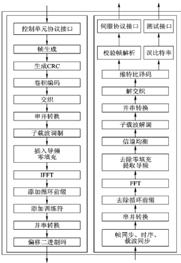
图9 调制解调器软件结构
