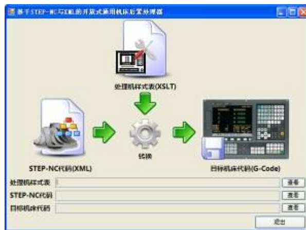
图 10 开放式 STEP-NC 通用机床后置处理器
