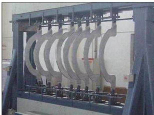
图6 飞机装配数控柔性多点工装
