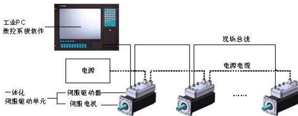
图3 数控系统硬件结构
